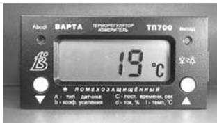
Терморегуляторы успешно работают в туннельных, муфельных и тигельных электропечах, термопластавтоматах, аппаратах термоупаковки и других электронагревательных приборах.
