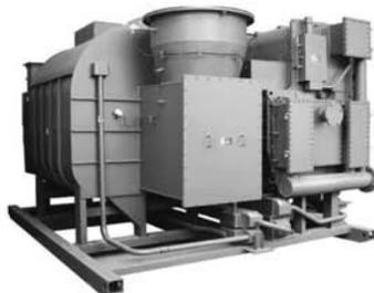
**АБХМ SS, ST, работающие на энергии пара. Выпускаются модели для давления пара от 0.1 до 1.6 МПа. Холодопроизводительность от 250 кВт до 7 МВт. С.О.Р. = 1.33. Чиллеры серии SS, ST используют тепловую энергию пара**
