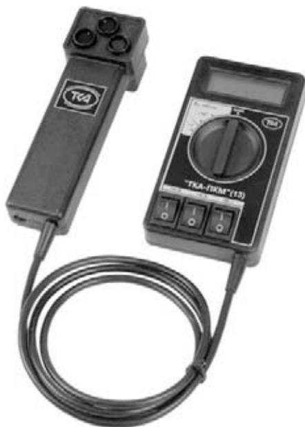
Рис. 4. Интегральный 3-зонный УФ-радиометр ТКА-ПКМ/13.
