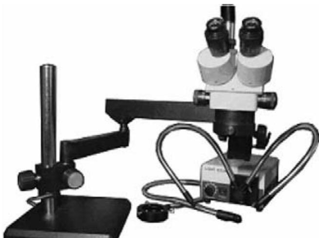
Функционально эти микроскопы предназначены для получения увеличенного трехмерного изображения объекта (без его специального приготовления) непрозрачного, полупрозрачного или прозрачного, помещенного на предметный столик.
