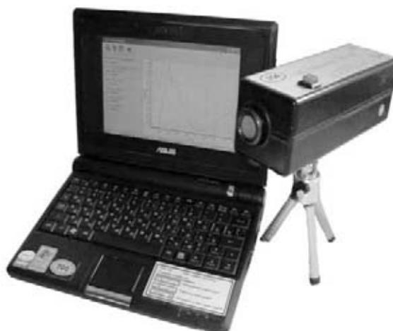
Рис. 5. Спектральный радиометр ТКА-ВД/УФ.
