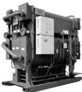
**АБХМ HSA, HSB, HSC, работающие на горячей воде. Температура используемой воды: 80~130 °С. Холодопроизводительность: 200 кВт ~ 10 МВт. С.О.Р. от 0.75 до 1.34. SL-чиллеры серий HSA, HSB, HSC используют для своей работы энергию горячей воды**
