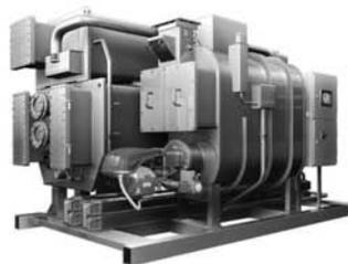
**АБХМ DF, работающие на прямом сжигании топлива. Используется природный или сжиженный газ, дизельное топливо, попутный или биогаз. Холодопроизводительность от 240 кВт до 5 МВт. COP 1.34 (0.92 в режиме теплоснабжения)**
